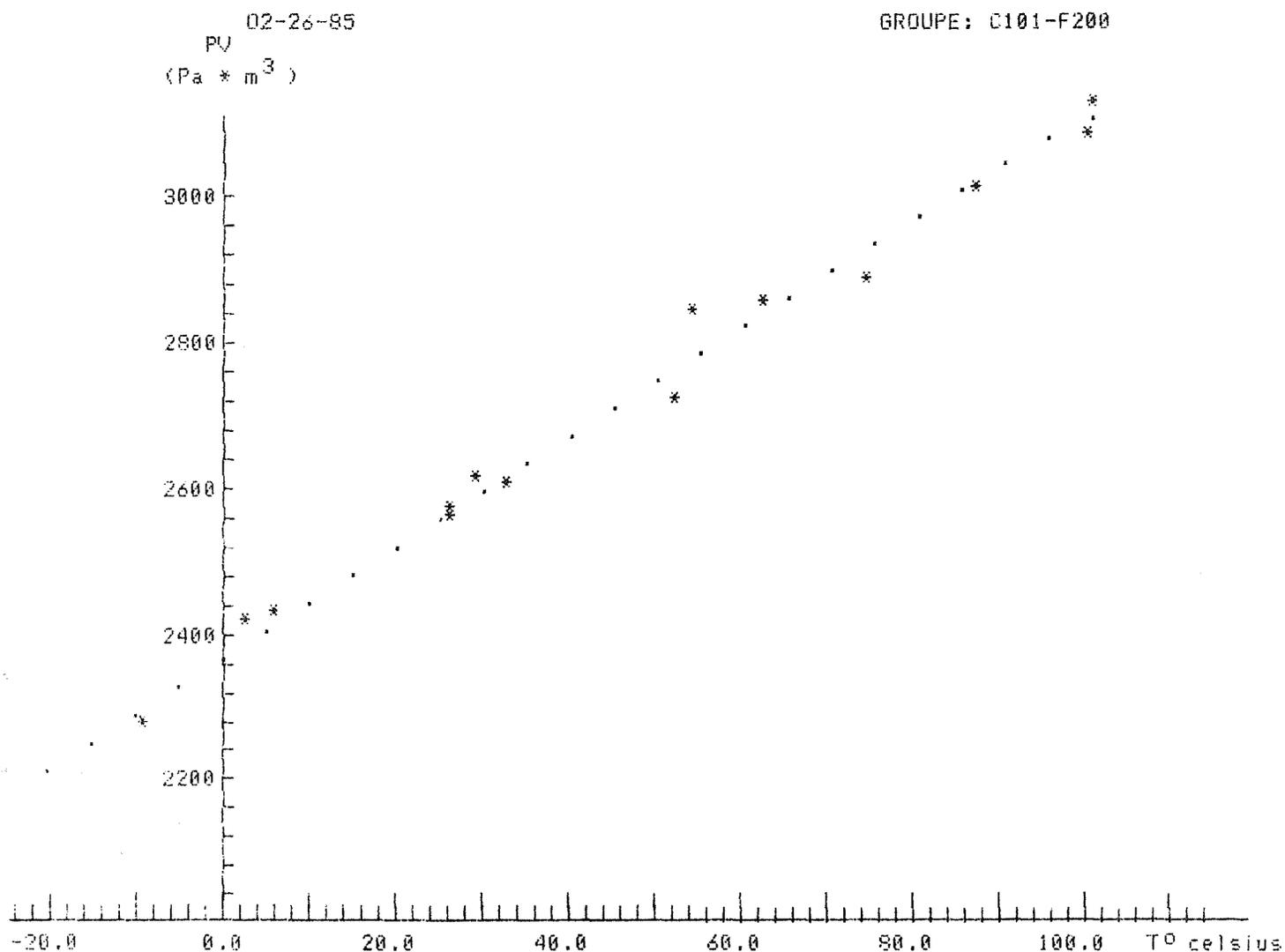
CARACTERISTIQUES DE LA DROITE PV (Pour 1 mole) versus T : \* utilisant PENTE \*
